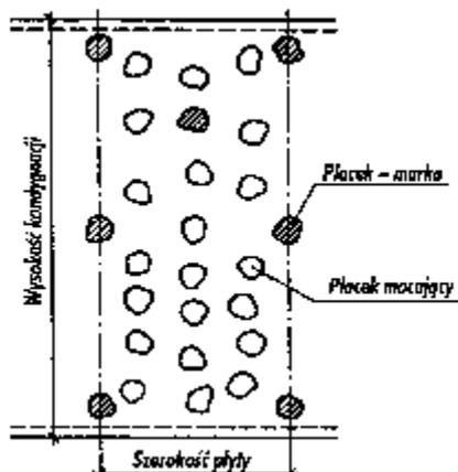
Płytę do przyklejania układa się stroną licową do podłogi w pobliżu miejsca jej zamontowania. Następnie na jej tylną stronę nakłada się placki zaczynu gipsowego w rozstawach od 30 do 35 cm.
